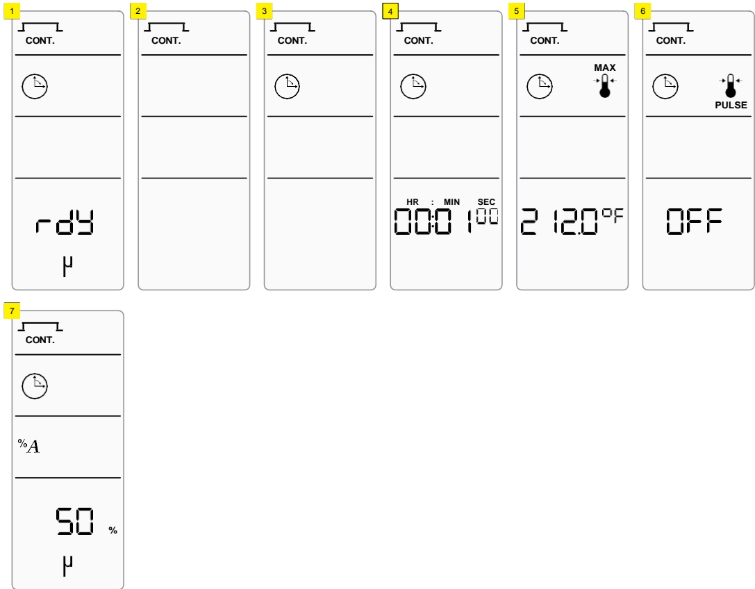
図 6.13 温度リミット - 連続発振 (時間) モード
