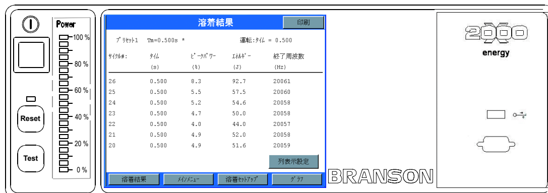
図 2.1 パワーアップ後の 2000Xeet パワーサプライの前面パネル *
